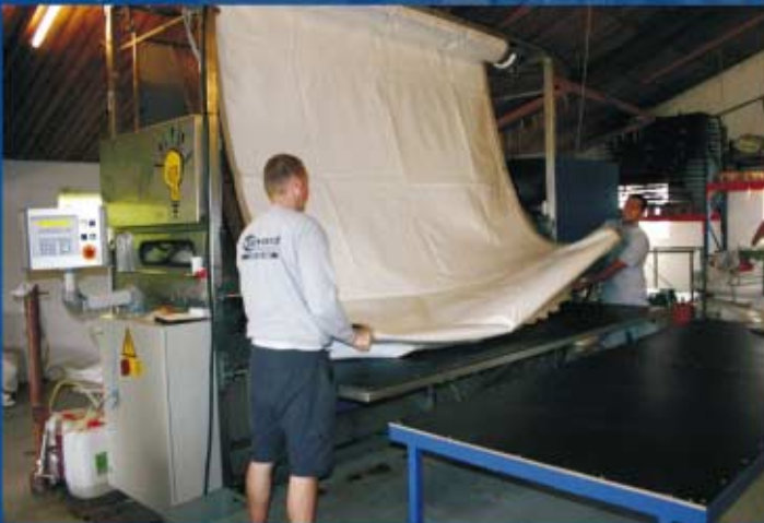
5. Dugen lufttørres via en kraftig blæser i kombination med et dieseldrevet fyr.
